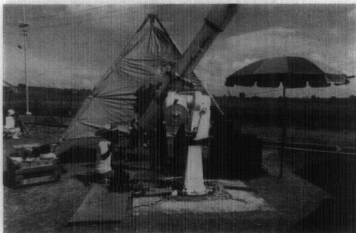
図 17 20 cm 赤道儀望遠鏡
